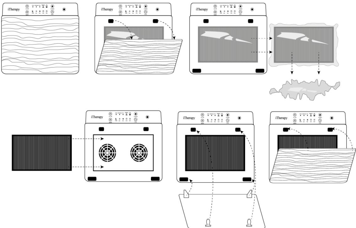
Grafički prikaz otvaranja prednjeg panela uređaja , uklanjanja zaštitne ambalaže sa iThe100 filtera i zatvaranja prednjeg panela uređaja.
