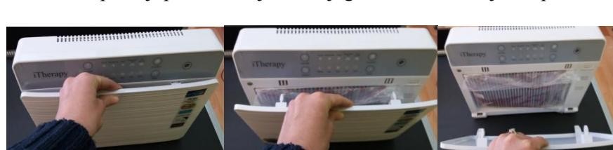
**2** Otvorite prednji panel uređaja iza kojeg se nalazi filter nježno povlačeći panel prema sebi i dolje .
