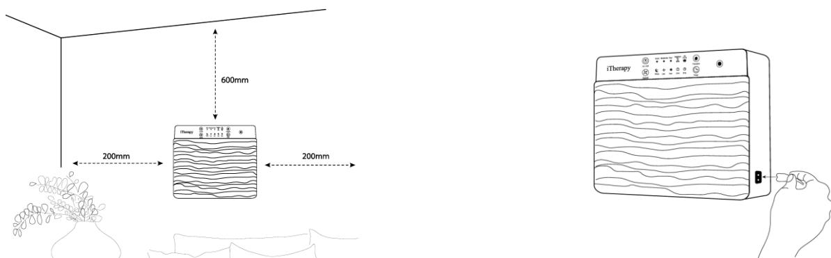
**6** Spojite napojni kabel u uređaj i uključite ga u napojnu utičnicu (110-240 V). Pritisnite tipku On/Off na uređaju ili na daljinskom upravljaču.
