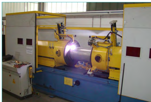
Automatsko zavarivanje bojlera od nehrđajućeg čelika
