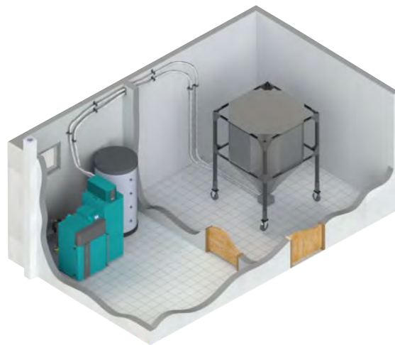
Primjer: Sistem vakuum dobave iz velikog spremnika (CentroPelet box)
