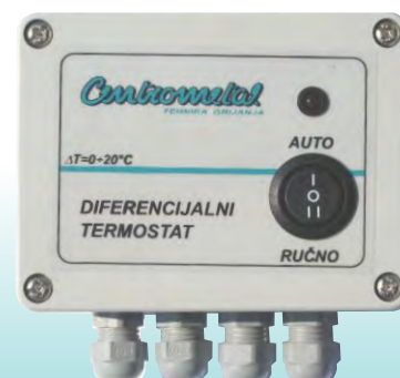
Diferencijalni termostat u kutiji za montažu na zid i pripadajućim osjetnicima
