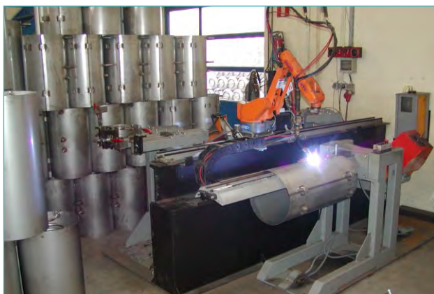
Robotsko zavarivanje bojlera od nehrđajućeg čelika
