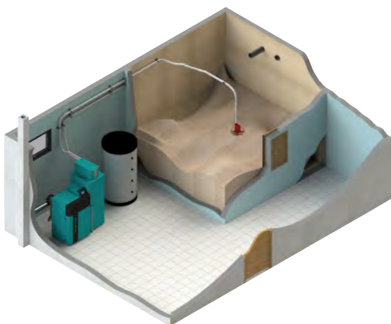
Primjer: Sistem vakuum dobave krticom iz prostorije / spremišta peleta
