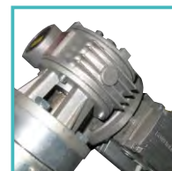
Motor s pužnim transporterom za dobavu peleta
