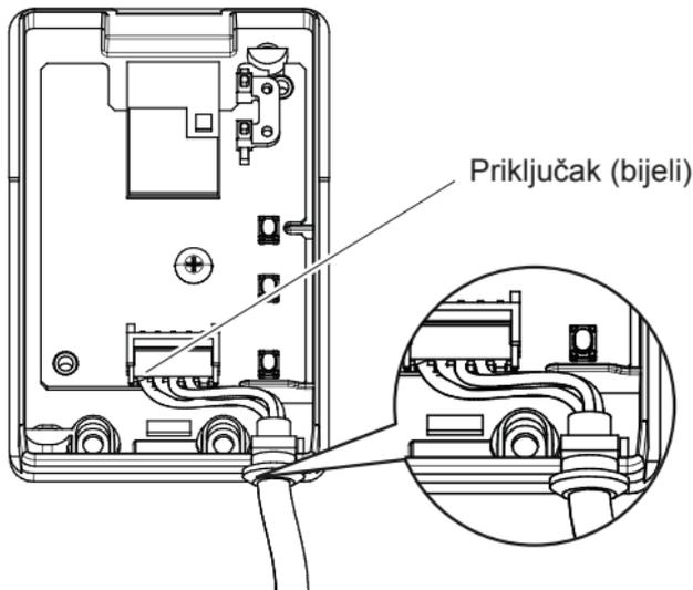
Učvrstite priključni kabel i osigurajte da se na njega ne prenose vanjske sile.
