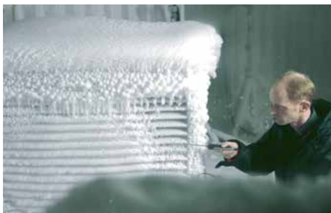
Namjenski timovi provode ispitivanja u ekstremnim klimatskim uvjetima u hladnim komorama
