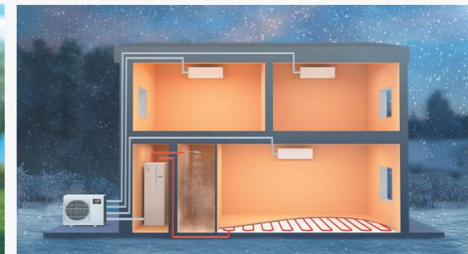
Slika 1. PXZ za ljetnu sezonu - hlađenje više prostorija pomoću ATA jedinica i opskrba potrošnom toplohom vodom pomoću ATW jedinice
