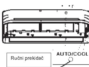
**NAPOMENA:** Uređaj se mora isključiti prije upotrebe ručnog prekidača. Ukoliko je uređaj uključen nastavite pritisakati ručni prekidač do isključenja uređaja.
