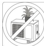
Pazite da ništa ne blokira sve ulaze i izlaze zraka
