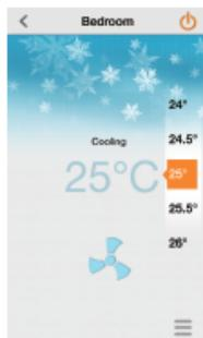
3. Brzina ventilatora: Koristi se za postavljanje brzine ventilatora. U načinu hlađenja ili grijanja, podesite brzinu ventilatora i funkcija postavki buke će se automatski ugasiti. Pogledajte u dijelu uputa u kojima se opisuju načini rada klima uređaja, za detaljnije opise.
