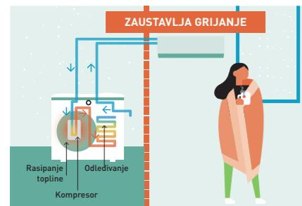
Čak i ako se grijanje zaustavi tijekom odleđivanja, pohranjena toplina nastavlja neprekidno zagrijavati prostoriju. To uklanja nelagodu zbog pada temperature prilikom privremenog zaustavljanja grijanja i osigurava stabilno grijanje klimatizacijskog uređaja.
