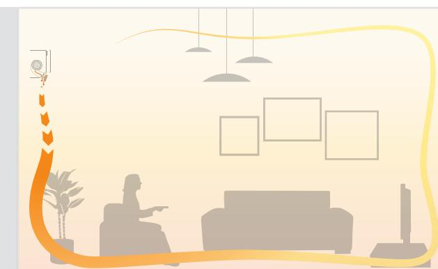
Na vrhu je prikazan Coanda efekt u načinu rada za hlađenje (stropni protok zraka), a donja slika pokazuje Coanda efekt u načinu rada za grijanje (vertikalni protok zraka).
